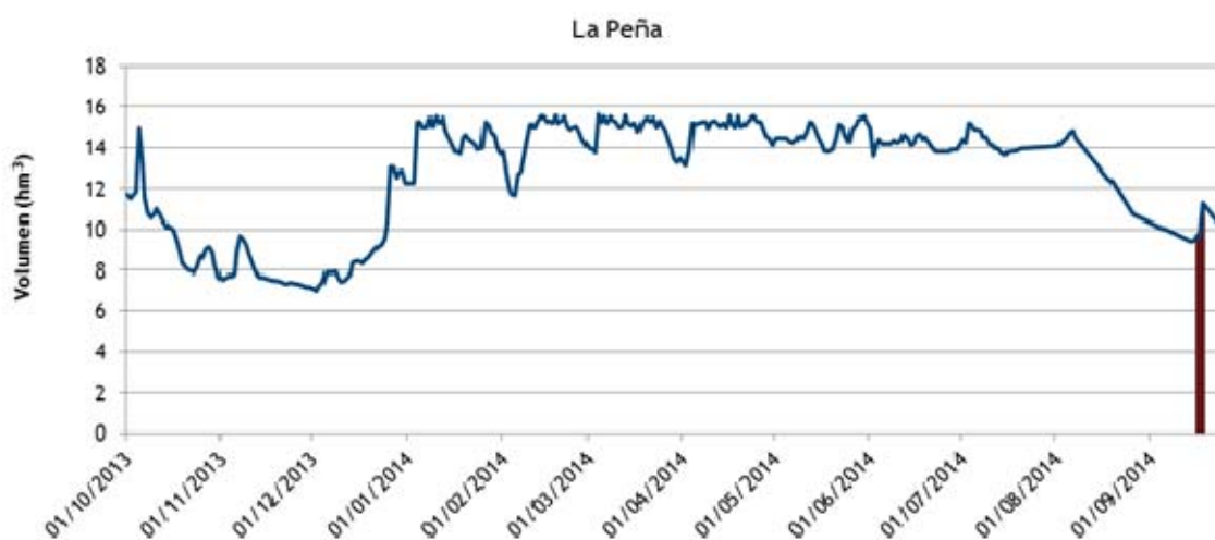
Figura 4. Evolución del volumen embalsado en el embalse de La Peña durante el ciclo hidrológico 2013/14
