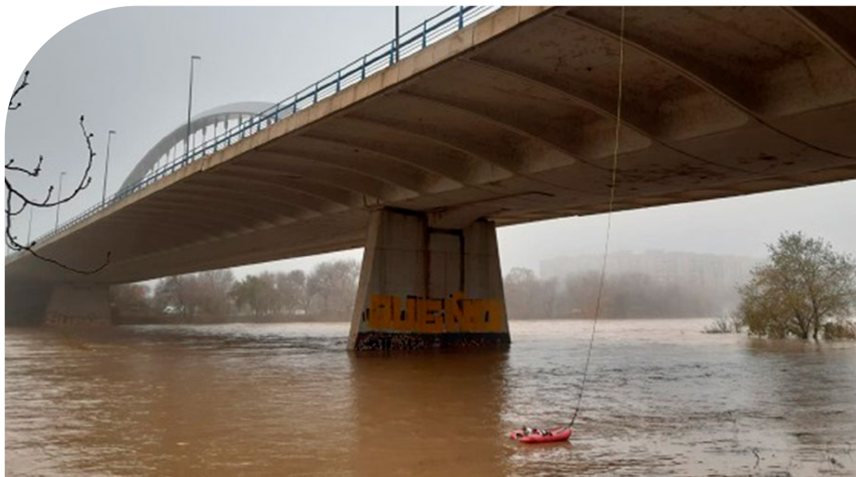
Aforo en Zaragoza el 14 de diciembre de 2021 con caudal superior a 2000 m 3 /s.
