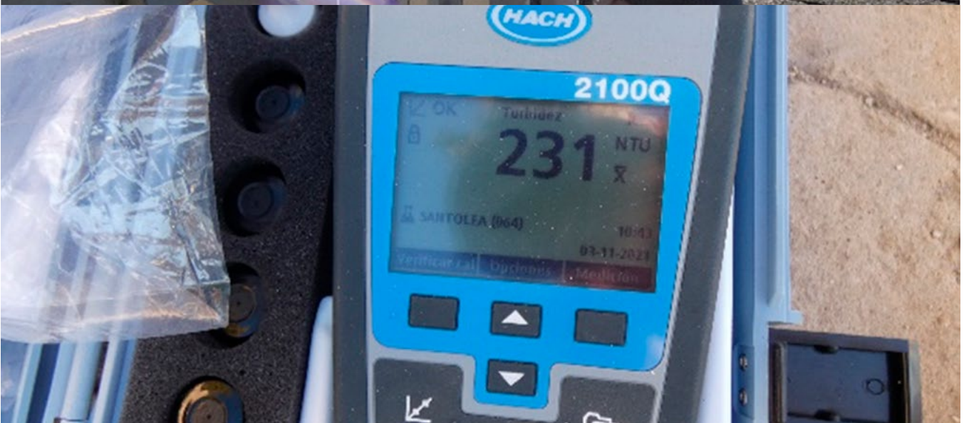
Seguimiento de la crecida controlada de 3 de noviembre de 2021. Toma de muestra para medida de turbidez y análisis de sólidos en suspensión. Flix-paso de barca.
