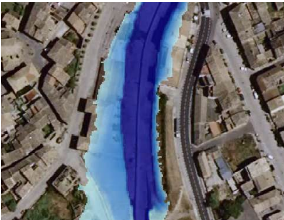
Figura 11.- Arriba: marcas de humedad en las escuelas de Sádaba tras la avenida de octubre de 2012. Abajo: extensión de la lámina de agua obtenida a partir del modelo hidráulico para un caudal equivalente.
