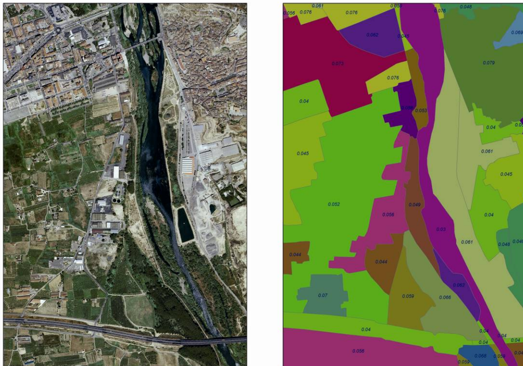
Figura 5.- Distribución espacial del coeficiente de rugosidad de Manning a partir la cartografía de usos del suelo del SIOSE y su revisión con la ortofoto PNOA de Máxima Actualidad (imagen correspondiente al entorno de Fraga, Huesca)
