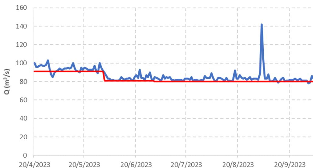
**Figura 19.** Caudales del río Ebro en Tortosa (azul) en 2023 y los caudales ecológicos para ese tramo (rojo).
