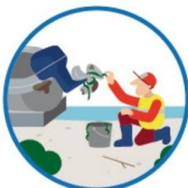
**REVISIÓN CON RETIRADA DE RESIDUOS, MATERIAL VEGETAL O ESPECIES** QUE HAYAN PODIDO ADHERIRSE AL CASCO O MOTOR DE LA EMBARCACIÓN. DESECHAR LO RECOGIDO EN UN CONTENEDOR DE RESIDUOS.
